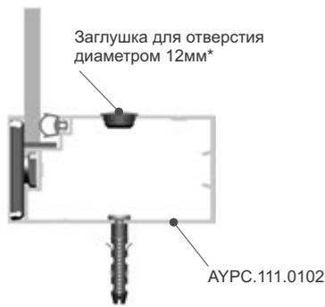
Крепление каркаса перегородки к полу, потолку, стенам. Диаметр предварительного отверстия под заглушку 12мм.
