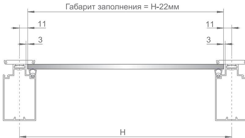
**Примечание:** величина зазоров (3мм на сторону заполнения), указанная на рисунке, носит рекомендательный характер при определении габаритных размеров заполнения, расчёт справедлив для профилей АУРС.111.0101, АУРС.111.0102, АУРС.111.0103, АУРС.111.0104, АУРС.111.0201.
